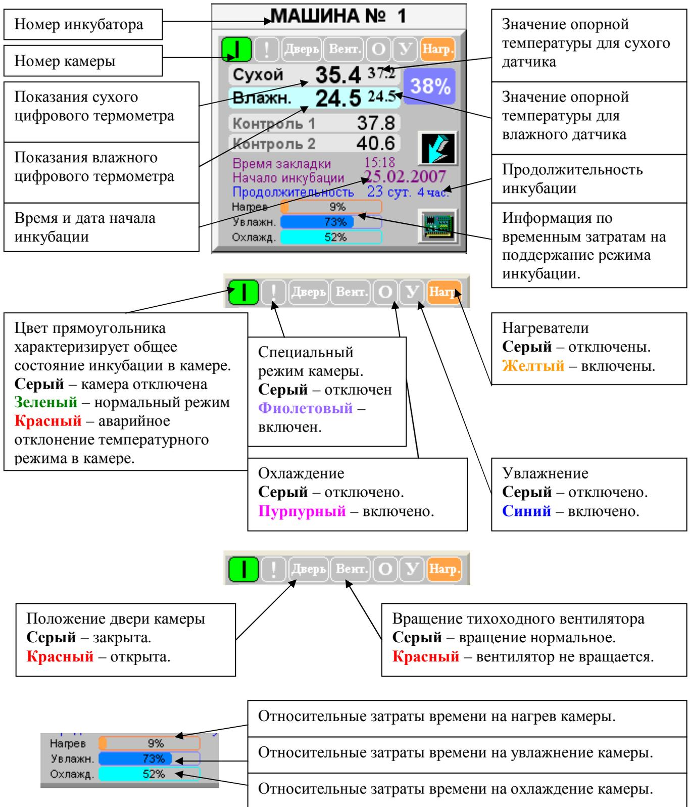
Эти данные собираются за последний час работы и позволяют оценить эффективность работы как инкубационной машины в целом, так и исправность работы отдельного оборудования.
