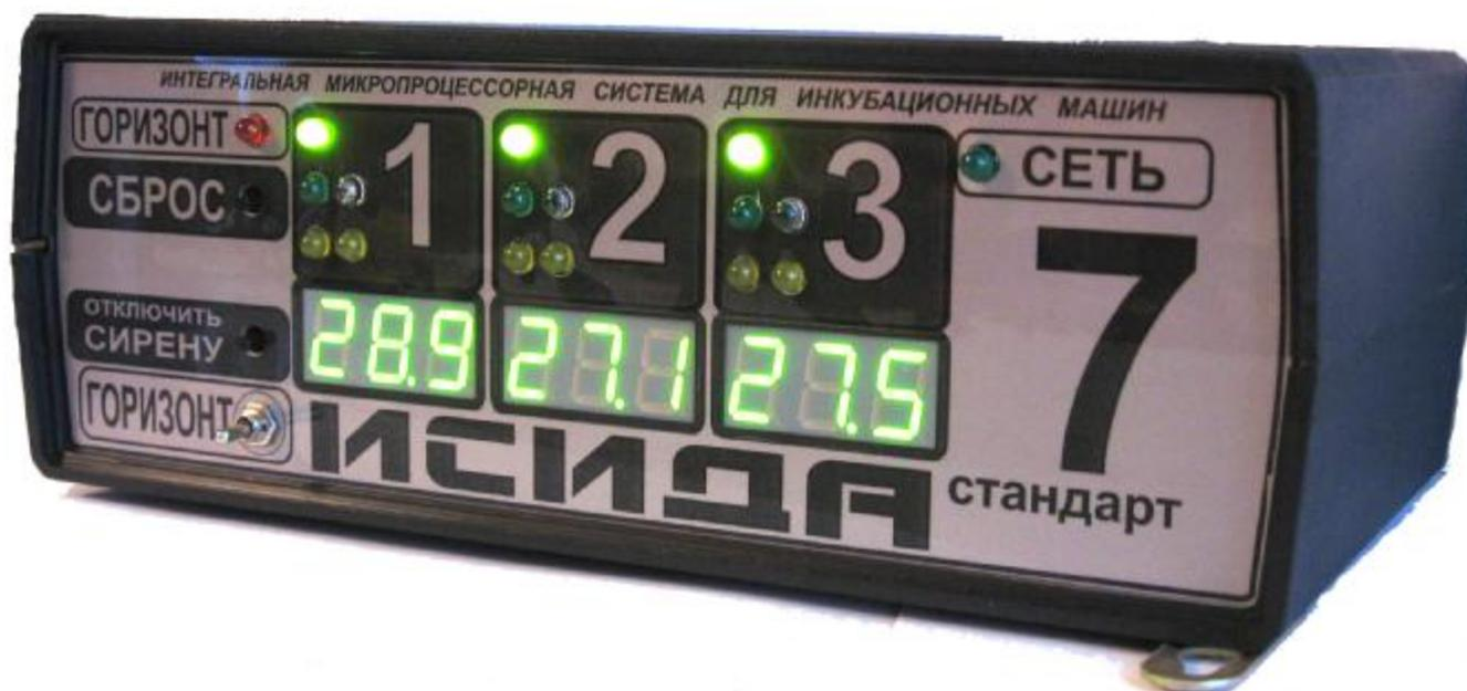
Лицевая панель электронного блока инкубатора состоит из трех групп светодиодных индикаторов по пять светодиодов в каждой группе, двух кнопок и одного переключателя.
